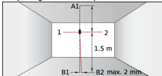
Den Laser auf Stativ oder Wandhalterung nahe Punkt A1 aufbauen, mit einem Mindestabstand von 1,5 m zu Punkt B1. Der horizontale Laser ist in Richtung 1 ausgerichtet. Laserpunkte A1 und B1 mit einem Stift markieren.
