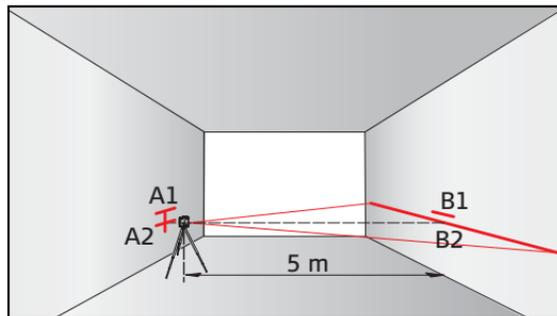
Anschliessend Instrument auf gleicher Höhe möglichst nahe zur Wand A platzieren und erneut die horizontale Laserlinie oder den Laserpunkt auf Wand A (-> A2) markieren. Instrument wieder um 180° drehen und Laser auf Wand B (-> B2) markieren. Abstände der markierten Punkte A1-A2 und B1-B2 messen. Differenz der beiden Messungen ermitteln. Wenn die Differenz 2 mm nicht überschreitet, befindet sich der CLL 11/PLL 11 innerhalb der Toleranz.
