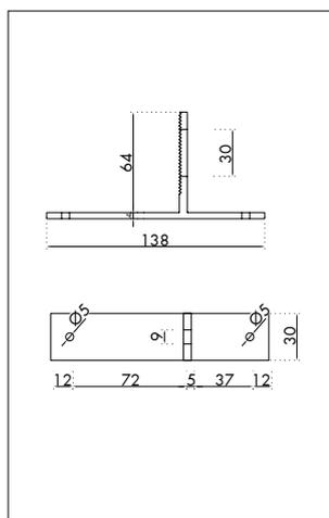
per il fissaggio di profilati Zebra SOLAR 39x37, 47x37, 60x37 e 70x44
