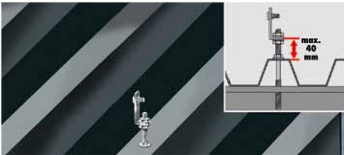
Identificare il punto di fissaggio secondo la progettazione. Montare la vite sempre nella cresta (parte alta) della copertura e perpendicolarmente alla pendenza del tetto. Avvitare il dado finché la guarnizione EPDM sarà aderente alla copertura. Montare l'angolo SOLAR tra i due dadi delle viti di congiunzione e serrare con una coppia di serraggio di 30-40 Nm per l'M10 e 50-60 Nm per le viti M12.
