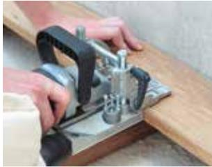
Fresare con la fresatrice per lamelle sul punto marcato.
