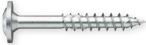
Vite a filetto parziale in acciaio inox A2 con testa larga per il fissaggio di robuste giunzioni legno-legno in costruzioni in legno in ambienti esterni costantemente esposti agli agenti atmosferici. Adatta anche per il fissaggio di ganci per pannelli solari e fotovoltaici.
