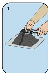
Selezionare la manichetta secondo la tabella. Tagliarla secondo il diametro del tubo desiderato (apertura, a seconda delle dimensioni del tubo, ca. 10-25 mm più piccola del diametro tubo)
