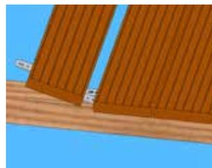
4. Si consiglia di posizionare la prima tavola al centro della struttura portante fissandola con le viti su entrambi i lati. Questo metodo di posa è vantaggioso poiché, in caso di sostituzione di una tavola danneggiata, la porzione di tavolato da rimuovere sarà limitata.
