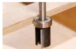
Il cuscinetto guida sulla fresa permette una fresatura facile e veloce senza rovinare la dima.
