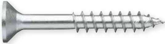
Vite a filetto parziale in acciaio inox speciale 1.4529 a resistenza alla corrosione molto alta con testa piana svasata per il fissaggio di giunzioni legno-legno in aree costantemente esposte a corrosione molto elevata, quali piscine (classe di resistenza alla corrosione V).
