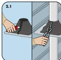
Per il montaggio su tubi già installati o in aree difficilmente accessibili tagliare completamente la manichetta lungo l'apposita nervatura inclusa la flangia di rinforzo in alluminio, avvolgere intorno al tubo, applicare silicone neutro nella nervatura e chiudere con le graffe in acciaio inossidabile Art. 0498 200 999 (non comprese nella confezione - da acquistare a parte).
