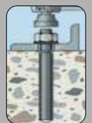
Posizionare l'elemento da fissare e serrare con chiave dinamometrica.
