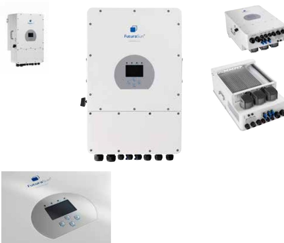
**Inverter trifase 10kW ibrido, adatto in impianti sia con batterie che senza. Può essere utilizzato come retrofit su impianti esistenti (sia AC che DC) ed è compatibile con i generatori diesel. 100% di sbilanciamento possibile su ciascuna fase; potenza massima su singola fase fino al 50% della potenza nominale**
