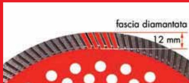
Il particolare sistema di foratura dell'anima impedisce al calore di propagarsi dai segmenti verso il centro.
